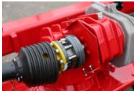
Transmission à sécurité Tulipmatic
