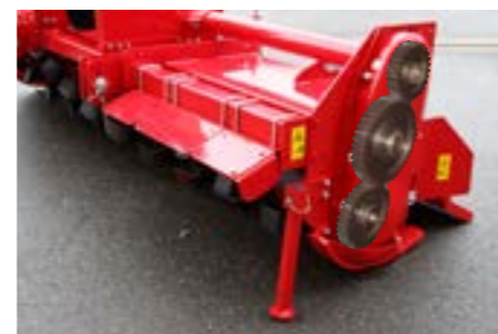
RTU avec entrainement latéral par pignons
