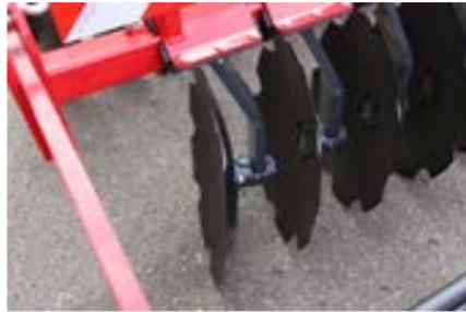
Suspension à barre de torsion des disques
