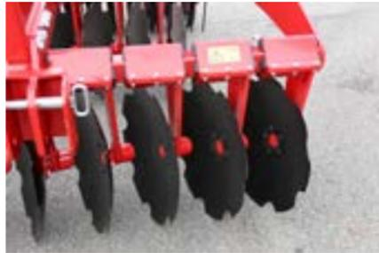
Suspension à barre de torsion des disques
