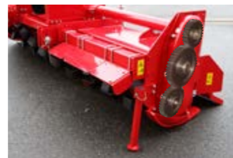
RTU avec entraînement latéral par pignons
