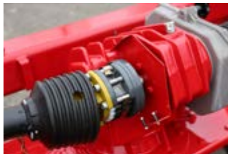
Transmission à sécurité Tulipmatic
