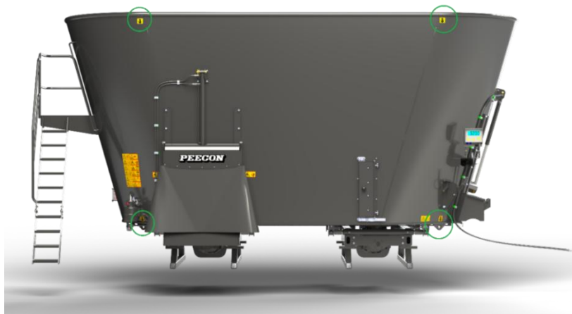
Abbildung 5-4 Mögliche Positionen der Hebepunkte
