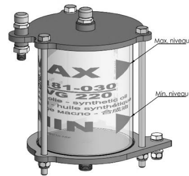
Abbildung 9-3: Ölbehälter des Planetengetriebes
