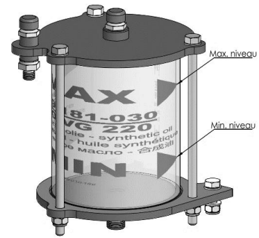
Figuur 9-3 Oliereservoir planetaire verteringskast
