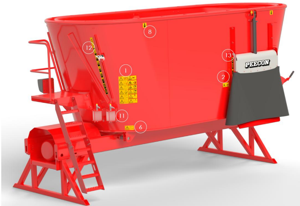
Abbildung 5.6 Sicherheitssymbole Biga stationärer Schneidmischbehälter
