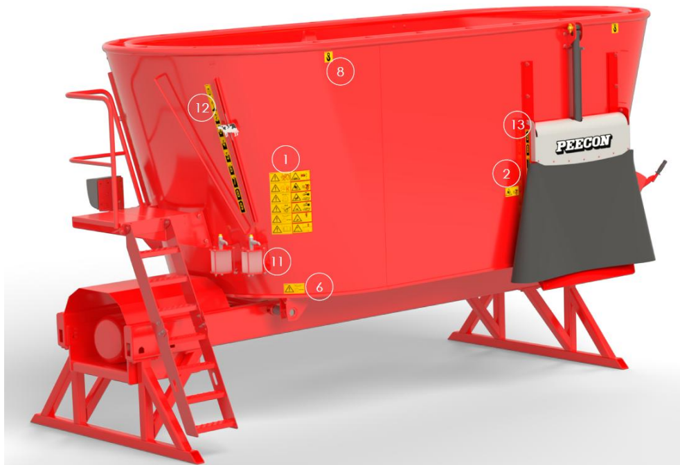
Kuva 5.6 Peecon Biga -stationaarisen seosleikkurin turvallisuussymbolit
