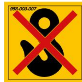
Figure 5.3 Point de levage non approprié
